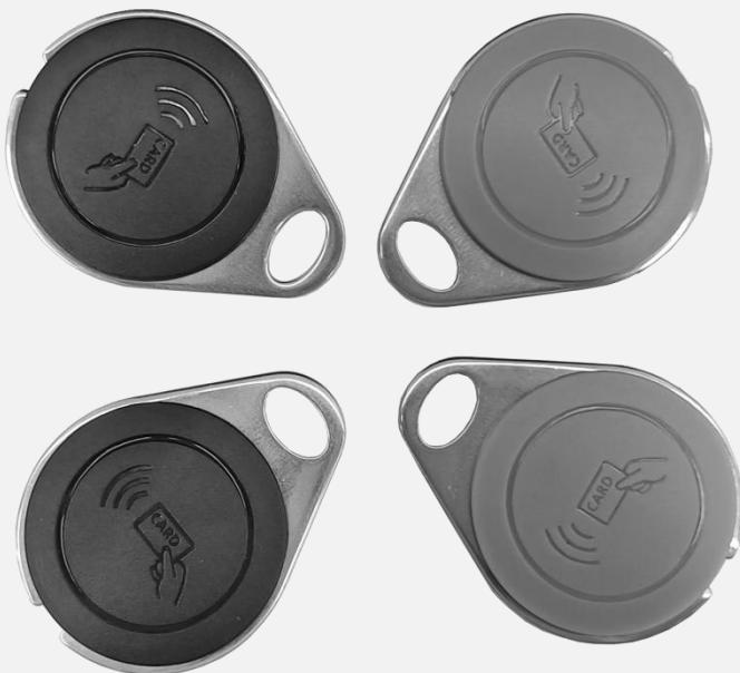
HC102 系列金属钥匙扣包含常规的 125KHz, 13.56MHz RFID 卡片, 具体有 TK4100、FM11RF08、S50、FM1208、DESFire EV3 这五款, 广泛应用于企业/校园一卡通、公交储值卡、高速公路收费、停车场、小区管理等。
